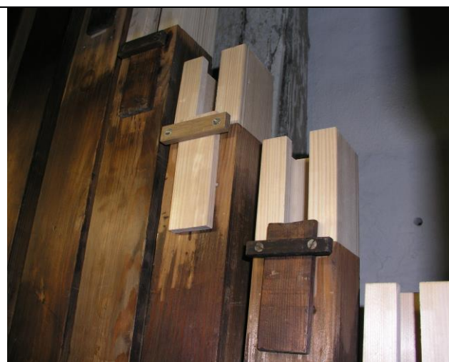
Les entailles des tuyaux de bois dans la forme typique de Ladegast
