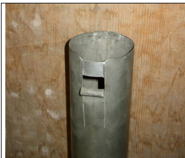
Ces entailles très cortés sont typiques des tuyaux de métal de Ladegast
